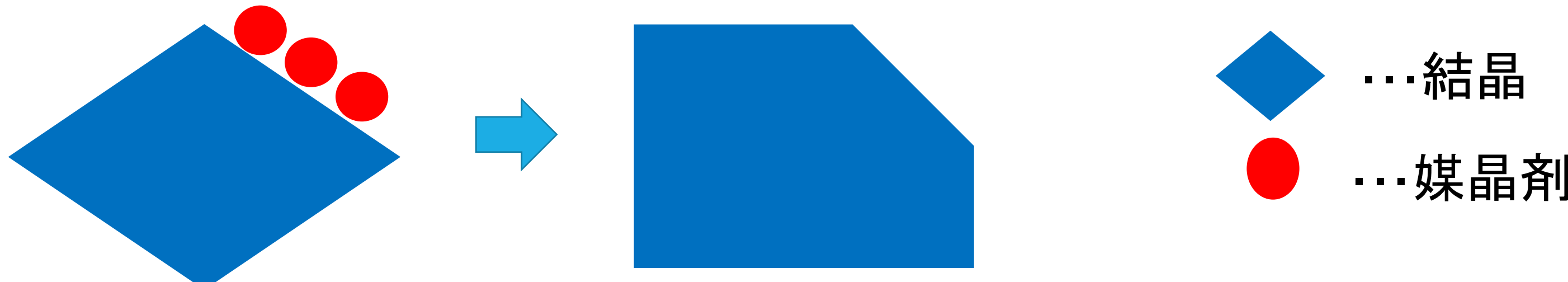
図1 媒晶剤による成長の阻害
